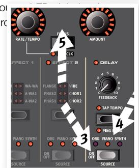
Wenn Sie mehr als einen Effekt in einem Programm aktiviert haben, können Sie mit der Focus-Taste den Fokus zwischen den Endlosreglern umschalten. Focus wird automatisch eingestellt, wenn ein neuer Effekt aktiviert wird.
