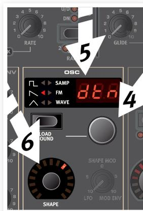
Der Shape-Parameter hat abhängig von der gewählten Wellenform verschiedene Aufgaben. So steuert er beispielsweise bei einigen Rechteck-Wellenformen die Pulsbreite, während er bei anderen Wellenformen überhaupt keine Funktion hat.
