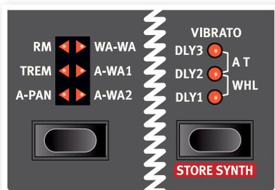
Mit den Auswahltasten wird eine Einstellung unter mehreren Optionen ausgewählt. Die aktuelle Auswahl wird dabei mit Hilfe von runden bzw. dreieckigen LEDs angezeigt. Durch mehrmaliges Drücken der Auswahltaste können Sie die Auswahlmöglichkeiten durchschalten.
