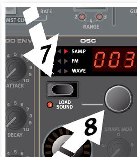
Diese Samples werden zuerst im Oscillator ausgewählt. Anschließend können Sie den Sound mit den anderen Synth-Parametern wie Filtern, Hüllkurven etc. formen.
