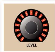
Die Potentiometer-Regler rechts werden beispielsweise in den Synth- und Effect-Sektionen genutzt. Wenn Sie durch die Programme blättern, entsprechen die physikalischen Positionen der Regler nicht zwangsläufig den aktiven Parameterwerten. Sobald diese Regler allerdings bedient werden, „springt“ der Parameter sofort auf die Position des Reglers.
