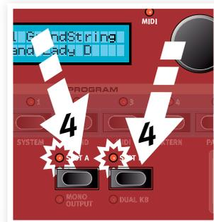
Die blinkende Slot-LED zeigt, welcher Slot momentan über die Bedienoberfläche editiert werden kann. Drücken Sie die andere Slot-Taste, wenn Sie den anderen Slot bearbeiten möchten.
