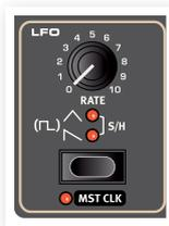
Die LFO-Frequenz wird über den Rate-Regler eingestellt. Der Einstellbereich liegt zwischen 0,03 und 523 Hz.
