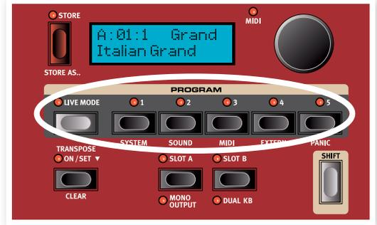
Die Live-Mode-Funktion von Nord stellt Ihnen fünf temporäre Programm-Puffer zur Verfügung, die Programm-Änderungen „on the Fly“ für Sie zwischenspeichern, ohne dass Sie einen Speichervorgang durchführen müssen.
