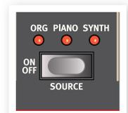
Sie können die verschiedenen Instrument-Zuordnungen auch durch zweimaliges Antippen der Source-Taste durchschalten. Diese Methode ist nützlich, wenn Sie nur eine Hand freihaben und daher die Shift-Taste nicht drücken können.
