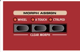
Um einen Morph zu aktivieren, halten Sie eine der Morph-Assign-Tasten gedrückt und drehen gleichzeitig einen Parameterregler in die gewünschte Richtung. Dabei müssen Sie beachten, dass der (die) gewünschte(n) Morph-Parameter vor dieser Zuordnung mit dem (den) gewünschten Anfangswert(e) gespeichert ist (sind).
