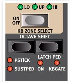
Um das Sustain-Pedal für ein Instrument zu aktivieren, halten Sie Shift gedrückt und drücken dann die linke Octave-Taste in der Sektion des jeweiligen Instruments. Die Sustped LED leuchtet, wenn die Funktion aktiviert ist. Drücken Sie die Taste erneut, um die Steuerung per Pitch Stick zu aktivieren, und ein drittes Mal, um beide Funktionen zu aktivieren. Wenn Sie die Taste ein viertes Mal drücken, werden beide Funktionen deaktiviert und keine der LEDs leuchtet mehr.
