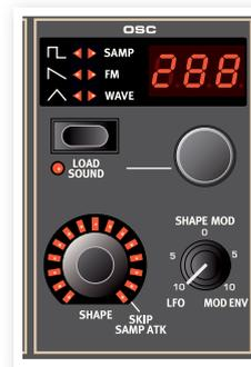
❶ *Werden Wavetables zur Klangerzeugung verwendet, ist der Shape-Regler ohne Funktion.*
